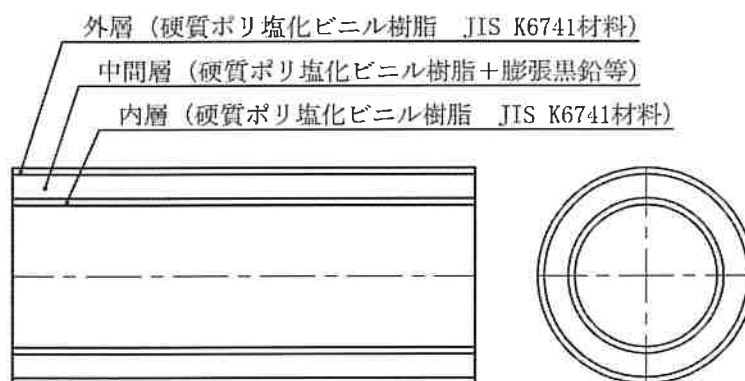
図－1 黒鉛混入硬質ポリ塩化ビニル管の断面構造
